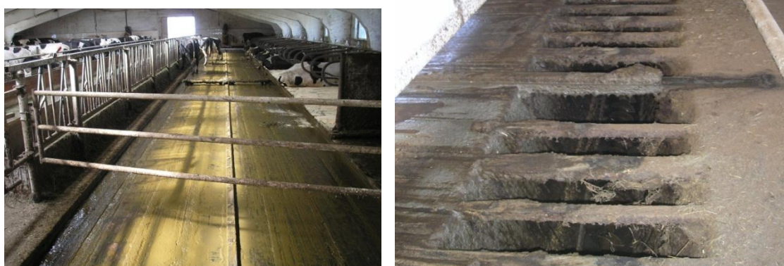
Рисунок 8 – слева – боксы для отдыха коров и навозный проход со скребковым транспортером; справа – решетки сборника-накопителя навоза
