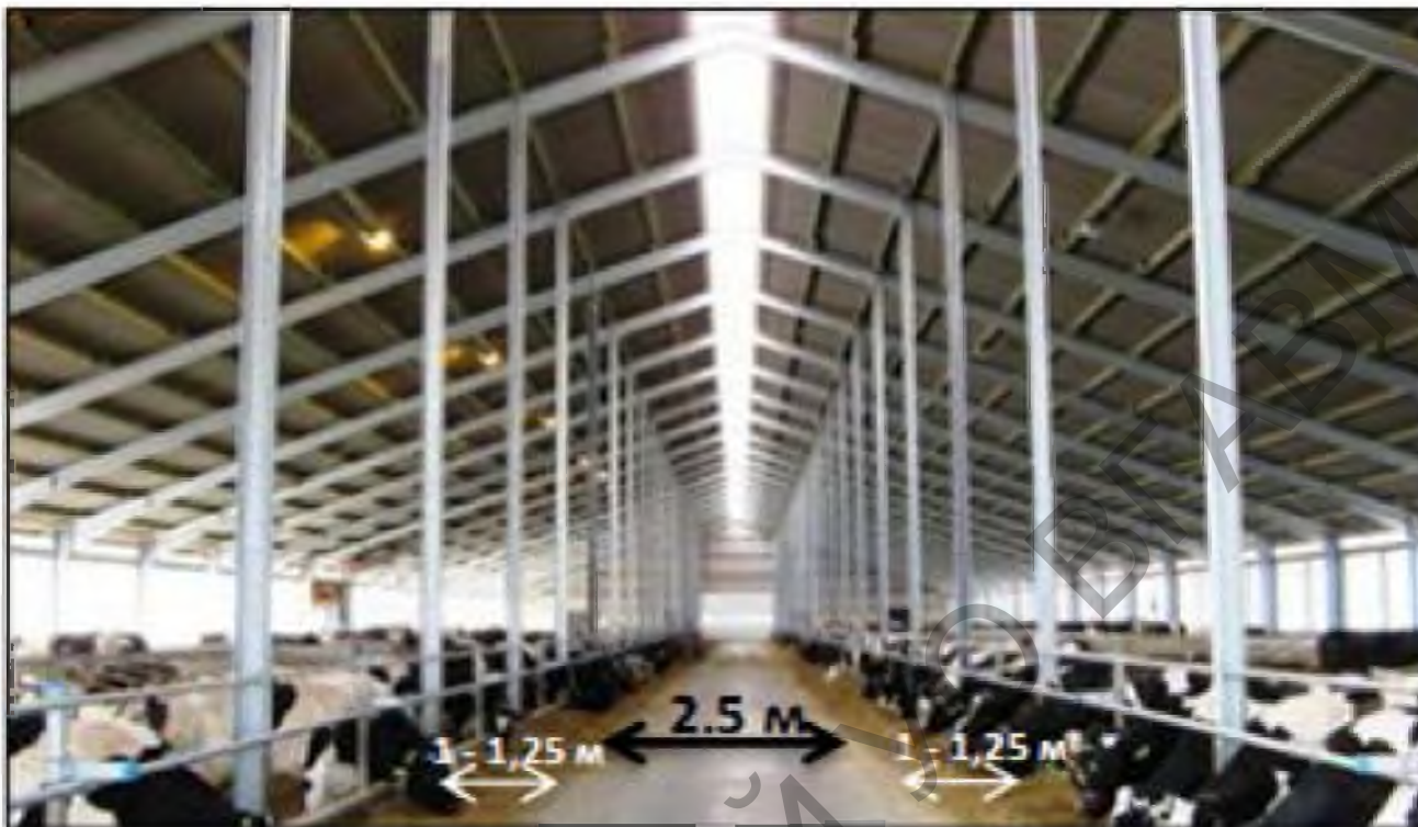
Рисунок 2 - Оптимальные параметры кормового проезда с двумя полосами кормового стола при беспривязно-боксовом содержании коров
