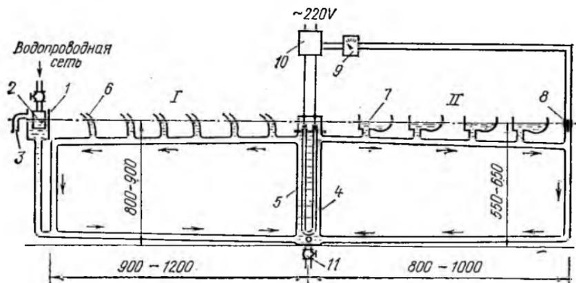
Рис. 8. Схема системы водопоения с бесклапанными поилками и электроподогревом воды (I — вариант с сосковыми поилками; II — вариант с чашечными поилками); 11 — вариант с чашечными поилками):
