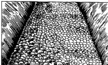
Рис. 63. Нерестовая панель с имитацией галечного субстрата конструкции Гидропроект и ЦПКТБ ВРПО «Запрыба»
