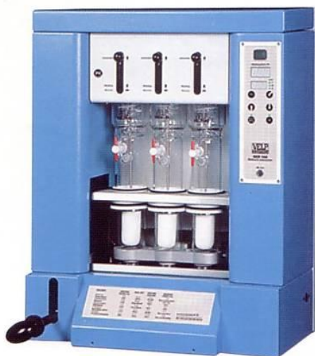
Рисунок 4. Автоматический аппарат для определения в кормах сырого жира
