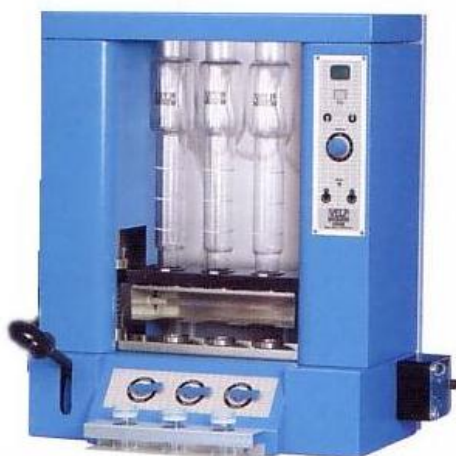
Рисунок 5. Автоматический аппарат для определения нейтрально- и кислотно-детергентной клетчатки, лигнина, целлюлозы, гемицеллюлозы
