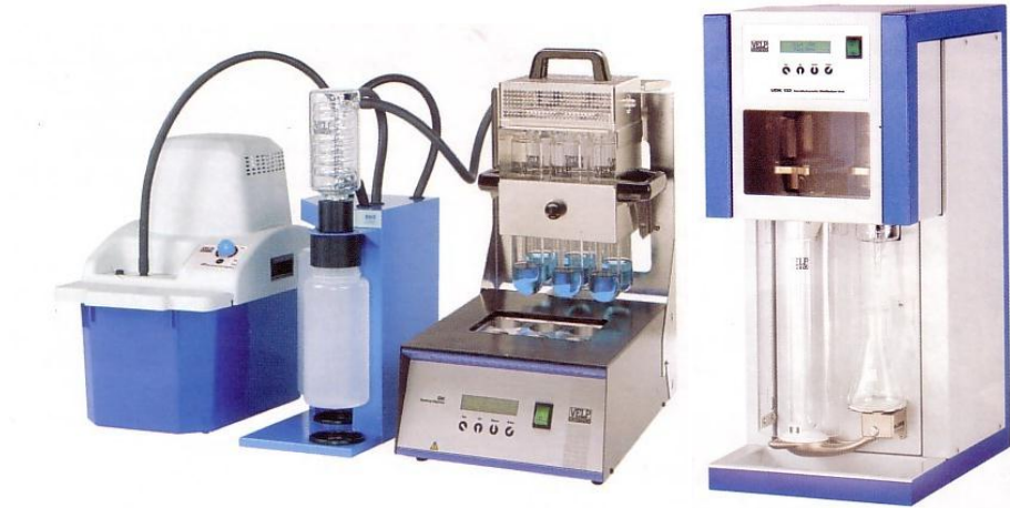
Рисунок 1. Комплект приборов для определения азота в кормах по методу Кьельдаля
