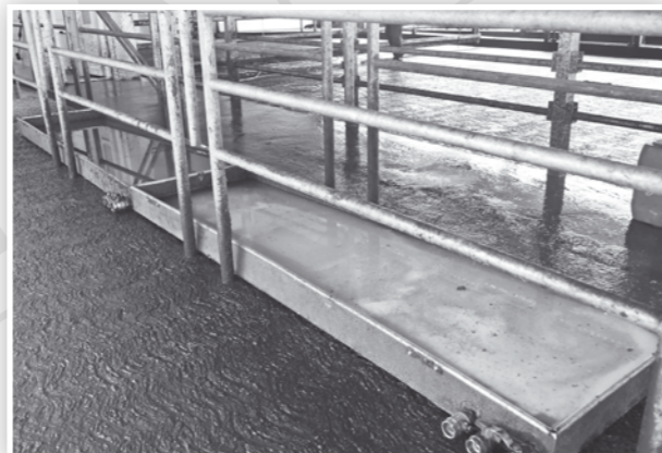
Рис. 17. Двойная ванна для обработки голени
