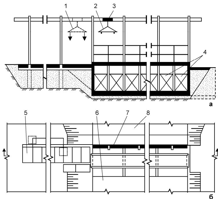
Рис. 3. Рыбозащитное сооружение с двухъярусной установкой кассет:
