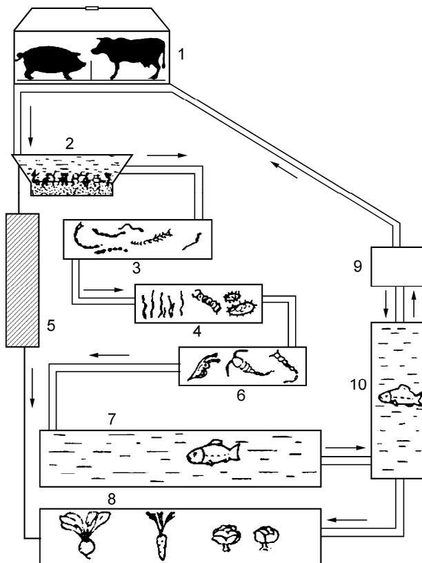
Рис. 22. Схема использования жидких навозных стоков из животноводческих помещений в качестве удобрений на рыболовной ферме:
