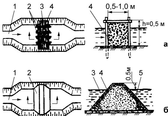
Рис. 4. Фильтры: а — хворостяной: 1 — канал; 2 — кольца (10-12 см); 3 — хворост; 4 — прижимные жерди (5-6 см); 5 — крепление; б — каменно-щебеночный: 1 — канал; 2 — фильтр; 3 — камень; 4 — щебень; 5 — крепления (Козлов, 1998)
