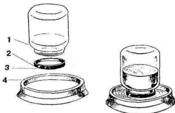
Рис. 13. Поилка вакуумного типа: 1 — емкость для воды; 2 — отверстие для вытекания воды; 3 — подставка; 4 — миска
