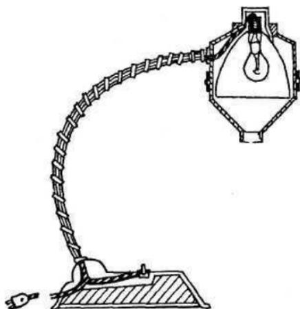
**Рис. 17. Овоскоп из настольной лампы**
