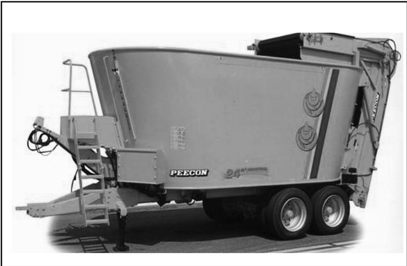
Привод от ВОМ трактора. Без устройства для самозагрузки. Система измельчения-смешивания – два вертикальных шнека. Комплектуется двумя гидравлически управляемыми контрножами, автоматической системой смазки, гидравлическим тормозом, двумя устройствами для выгрузки (с гидравлически управляемыми заслонками), шасси типа «Тандем», прицепным устройством, лестницей, механической опорой.
