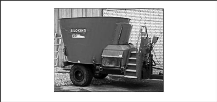
Кормораздатчик-смеситель VM 9 «Siloking» производит смешивание загружаемых компонентов корма с неравномерностью 23,3 %, транспортировку кормосмеси без потерь, раздачу кормосмеси с неравномерностью по длине кормовой линии 19,1 % при фактической норме раздачи 56,4 кг/м пог. и скорости движения агрегата 2,4 км/ч. При раздаче кормосмеси на кормовой стол потерь не отмечается.
