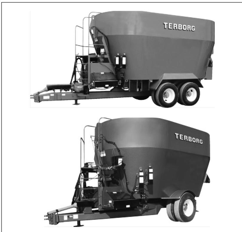
Кормосмесители, предлагаемые Терборг Агро, позволяют тщательно перемешивать комбикорма и добавки и получать идеальный рацион с минимальными затратами. Кормосмесители оснащены шнеками для перемешивания компонентов кормовой смеси и ножами для резки длинных волокон. Они отлично справляются с переработкой тюков соломы и силоса с высоким содержанием влаги.
