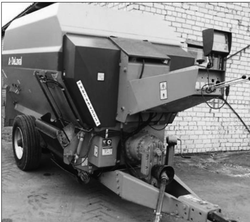
Кормосмеситель-кормораздатчик компании ДеЛаваль смешивает и раздает различные виды кормов: длинностебельчатые, силосы, сенажи, концентраты и корнеклубнеплоды; может измельчать и смешивать длинностебельчатую солому и сено с другими видами кормов. Оснащен тремя шнеками и специальными ножами и противножами. Может быть использован в комбинации с подвесным кормораздатчиком и станциями кормления коров концентратами.
