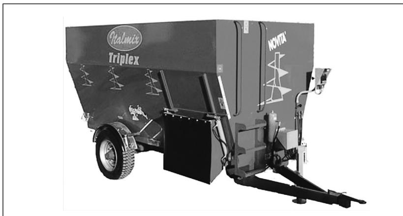
Особая форма позволяет совместить кормосмеситель малых габаритов с вертикальным типом микса, что обеспечивает однородность и мягкость при измельчении и перемешивании продукта. Буксируемые кормосмесители серии TRIPLEX снабжены 3 вертикальными спиралевидными шнеками дифференциального диаметра с ножами (5 ножей на шнеке). Возможность измельчения рулонов без предварительной резки.
