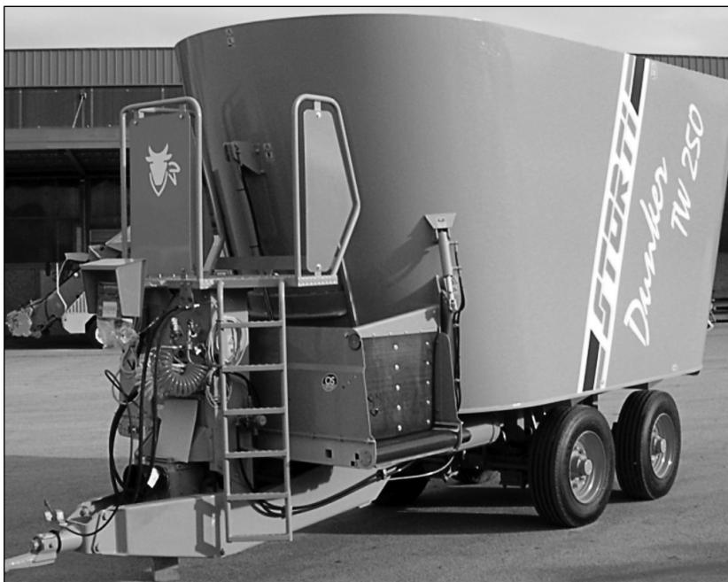
Миксер-кормораздатчик (смеситель-кормораздатчик, кормосмеситель) служит для измельчения, смешивания и последующей раздачи кормов для крупного рогатого скота. Существует два основных типа подобных машин – горизонтальные и вертикальные. Машины различаются по объёму бункера – обычно от 9 до 16 м<sup>3</sup>, количеству шнеков, наличию загрузочной фрезы и т. д.
