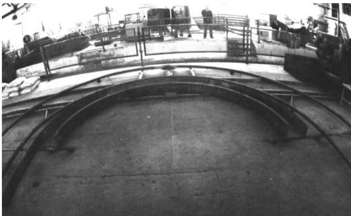
Рис. 2.2. Испытательный стенд для передвижения электромобильного кормораздатчика по криволинейному рельсовому пути
