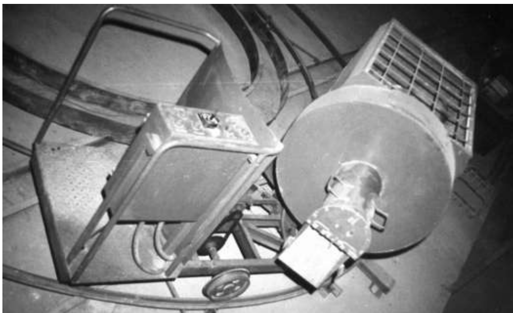
Рис. 2.1. Общий вид кормораздатчика с шарнирно сочлененной ходовой частью
