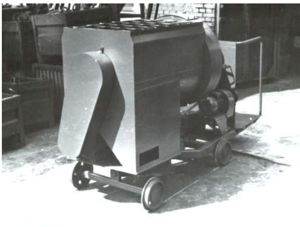
Рис. 4.5.11. Общий вид кормораздатчика КС-Ф-0,5 с вместимостью бункера 0,5 \text{ м}^3
