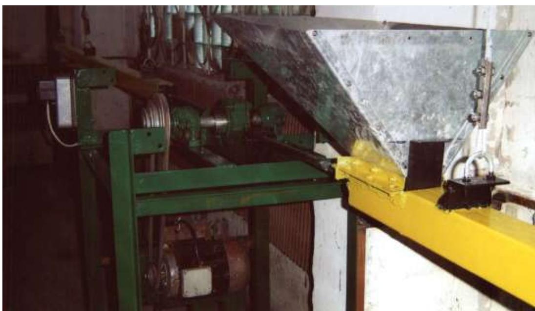
Рис. 6.2.3(в). Фрагмент узла экспериментального качающегося транспортера – загрузочная воронка
