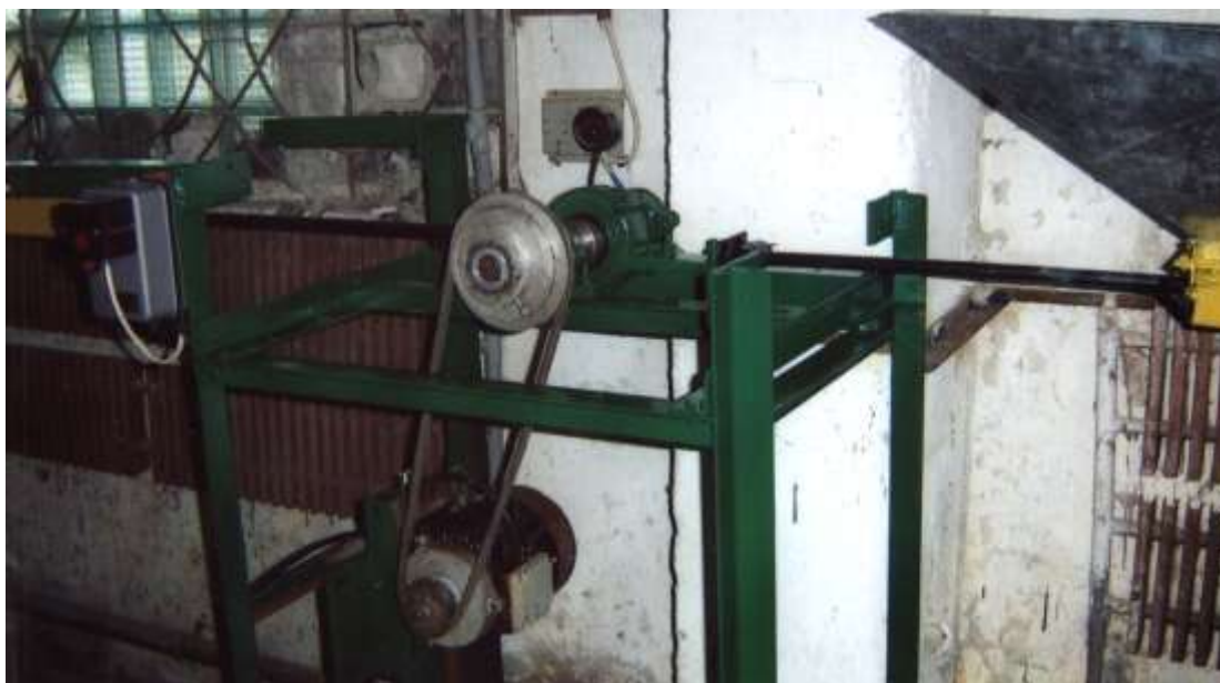
Рис. 6.2.3(б). Фрагменты узлов экспериментального качающегося транспортера - приводная станция с эксцентриковым механизмом
