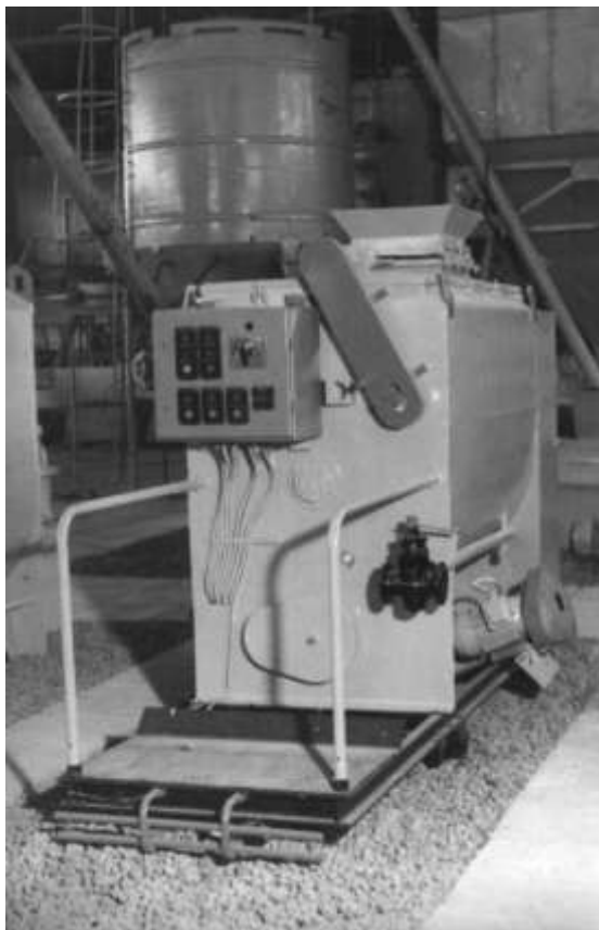
Рис. 7.2.1. Общий вид электромобильного рельсового агрегата для запаривания, смешивания и раздачи кормов свиньям
