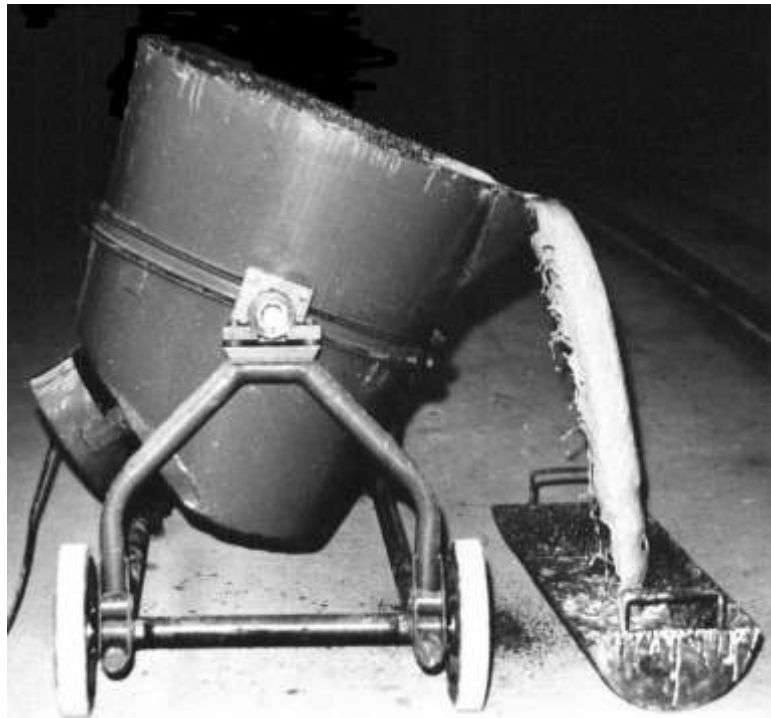
Рис. 7.3.5. Выгрузка корма путем наклона ковша
