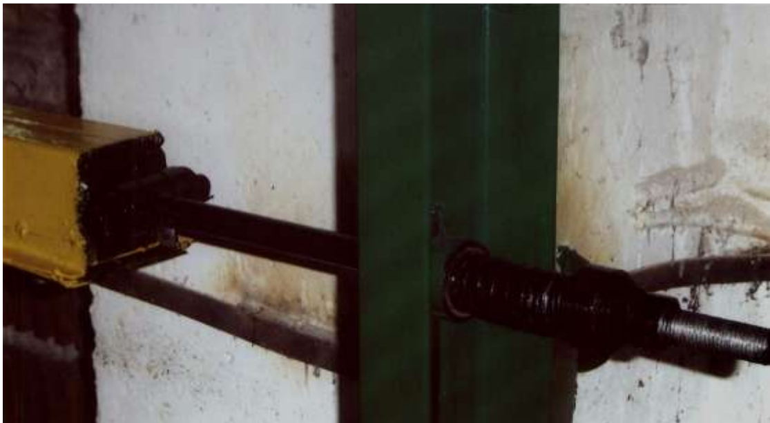
Рис. 6.2.3.(а) Фрагменты узлов экспериментального качающегося транспортера - задняя опорная стойка для штока с пружиной
