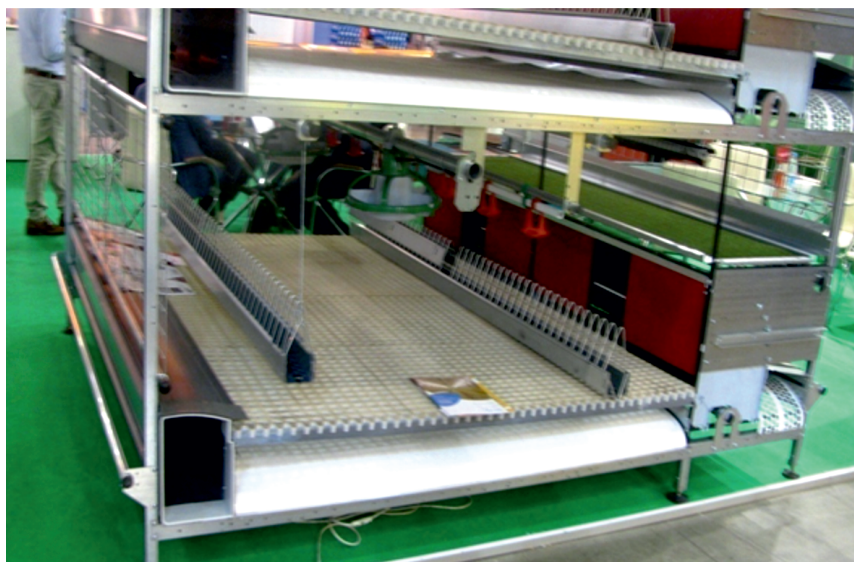
Рис. 2.5. Клеточная батарея для содержания родительского стада мясных кур (фирма «Vencomatic» (Голландия)
