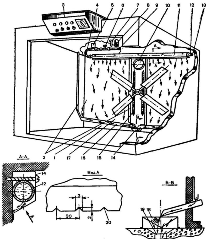
**Рис. 4. Инкубатор «Универсал-55» с открытым теплообменником:**
