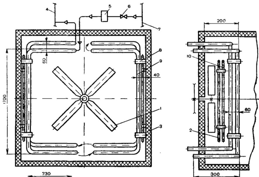
**Р и с. 3. Установка водяного охладителя и дополнительного нагревателя в выводной секции инкубатора «Универсал-55»:**
